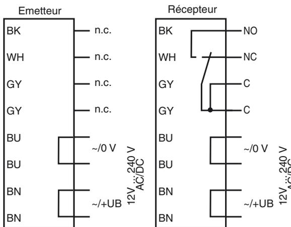
Les fonctions relais "contact d'ouverture" et "contact de fermeture" se rapportent au mode de commutation "Commutation forcé", position que les deux inverseurs clair/foncé doivent avoir (= réglage d'origine).
