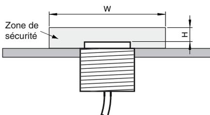
Ne pas utiliser d'objets métalliques dans la zone de sécurité pendant le fonctionnement.
