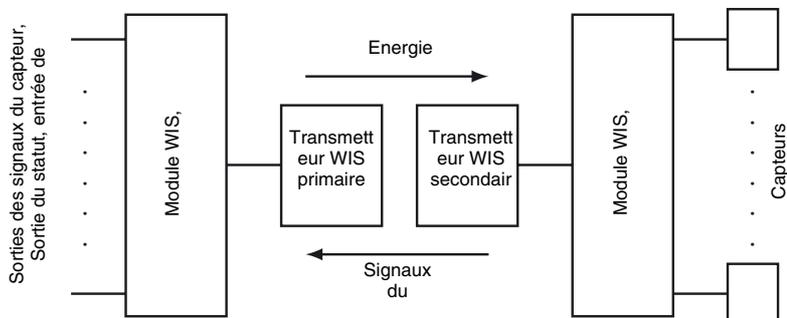
La somme des courants de repos de tous les capteurs reliés au module WIS secondaire ne doit pas excéder le courant transmissible maximal. Celui-ci correspond à la puissance transmissible par les transmetteurs / 12 V.
