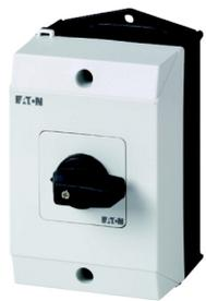
Commutateurs à gradins, Contacts: 8, 20 A, plastron: 1-8, 45 °, à accrochage, Montage en saillie
