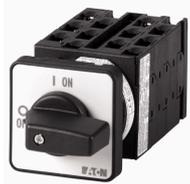
Commutateurs à gradins, Contacts: 12, 20 A, plastron: 1-4, 45 °, 4 crans 45°, à accrochage, Montage encastré
