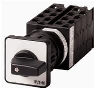
**Commutateurs à gradins, Contacts: 15, 20 A, plastron: 1-5, 45 °, à accrochage, Montage encastré avec fixation centrale**
