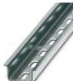
Profilé percé, Profil standard, largeur: 35 mm, hauteur: 15 mm, similaire à EN 60715, matériau: Acier, galvanisé, passivation blanche, longueur: 2000 mm, coloris: argenté
