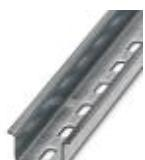
Profilé percé, Profil standard, largeur: 35 mm, hauteur: 15 mm, similaire à EN 60715, matériau: Acier, galvanisé, longueur: 2000 mm, coloris: argenté
