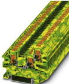
Bloc de jonction pour conducteur de protection, type de raccordement: Raccordement Push-in, nombre de connexions: 3, section : 0,14 mm<sup>2</sup> - 4 mm<sup>2</sup>, AWG: 26 - 12, largeur: 5,2 mm, hauteur: 45,7 mm, coloris: vert/jaune, type de montage: NS 35/7,5, NS 35/15
