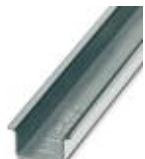
Profilé plein, Profil standard, largeur: 35 mm, hauteur: 15 mm, similaire à EN 60715, matériau: Acier, galvanisé, passivation blanche, longueur: 2000 mm, coloris: argenté
