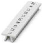
Repérage ZB, Rubans, blanc, repéré, longitudinal: L1, L2, L3, N, PE, L1, L2, L3, N, PE, type de montage: encliquetage dans la rainure de repérage élevée, pour bloc de jonction au pas de : 5,2 mm, surface utile: 5,15 x 10,5 mm
