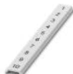
Repérage ZB, plat, Rubans, blanc, repéré, impression transversale: numérotation continue 1 ... 10, 11 ... 20, etc. jusqu'à 91 ... 100, type de montage: encliquetage dans la rainure de repérage plate, pour bloc de jonction au pas de : 5 mm, surface utile: 5,15 x 5,15 mm
