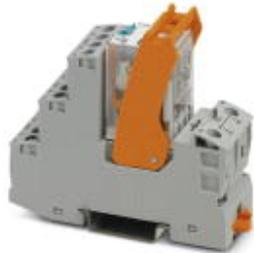
Module à relais prééquipé avec raccordement vissé, comprenant : embase de relais, relais à contacts de puissance et étrier de fixation. Type de contact : 2 contacts inverseurs. Tension d'entrée : 24 V DC
