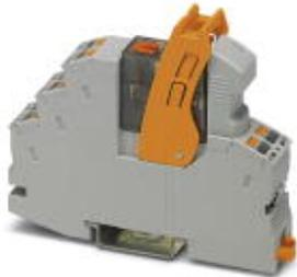
Modules à relais prééquipés avec raccordement push-In, comprenant : embase de relais, étrier de fixation du relais, module antiparasite enfichable et relais à contacts de puissance avec touche de contrôle et LED de statut intégrée. Type de contact : 2 contacts inverseurs. Tension d'entrée : 230 V AC
