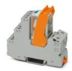
Module à relais prééquipé avec raccordement vissé, comprenant : embase de relais, relais à contacts de puissance et étrier de fixation. Type de contact : 4 contacts inverseurs. Tension d'entrée : 125 V DC
