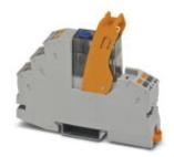
Module à relais prééquipé avec raccordement push-In, comprenant : embase de relais, étrier de fixation du relais, module antiparasite enfichable et relais à contacts de puissance avec touche de contrôle, LED de statut et diode de roue libre intégrées. Type de contact : 2 contacts inverseurs. Tension d'entrée : 24 V DC
