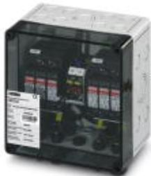
Coffrets de raccordement de générateur pour installations photovoltaïques jusqu'à 1000 V DC pour le raccordement de 2 x 1 string. Avec protection antisurtension et connecteur DC SUNCLIX pour les côtés entrée et sortie.
