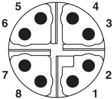
Schéma des pôles, connecteur mâle M12, 8 pôles, vue côté mâle
