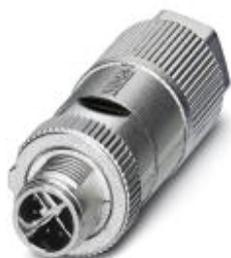
Connecteur, Ethernet CAT6<sub>A</sub> (10 Gbit/s), 8-pôles, exempt d'halogène, blindé, Connecteur droite M12 SPEEDCONNEC, Détrompage X, Raccordement autodénudant, matériau de la molette: Zinc moulé sous pression, nickelé, diamètre extérieur du câble 5 mm ... 9,7 mm
