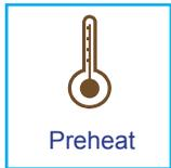
L'utilisateur peut contrôler la température de l'extrudeuse et du lit d'impression en touchant l'icône de préchauffage.
