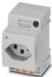
Prise, Modèle d'enchâssement type J, Raccordement à ressort Push-in, avec témoin lumineux, pour la Suisse et autres pays, gris, pour montage sur profilé dans une interface de service ou pour montage direct, 250 V AC, 16 A, -20 °C, 60 °C, SEV 1011
