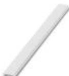
Repérage ZB, plat, Rubans, blanc, vierge, repérable avec : CMS-P1-PLOTTER, PLOTMARK, type de montage: encliquetage dans la rainure de repérage plate, pour bloc de jonction au pas de : 16 mm, surface utile: 16,25 x 10,5 mm
