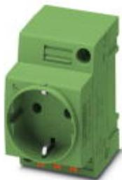
Prise, Modèle d'enchâssement de type CF, Raccordement à ressort Push-in, Voyant, vert, pour montage sur profilé dans une interface de service ou pour montage direct, 250 V AC, 16 A, -20 °C, 60 °C, VDE 0620-1
