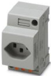
Prise, Modèle d'enchâssement type J, Raccordement à ressort Push-in, pour la Suisse et autres pays, gris, pour montage sur profilé dans une interface de service ou pour montage direct, 250 V AC, 16 A, -20 °C, 60 °C, SEV 1011
