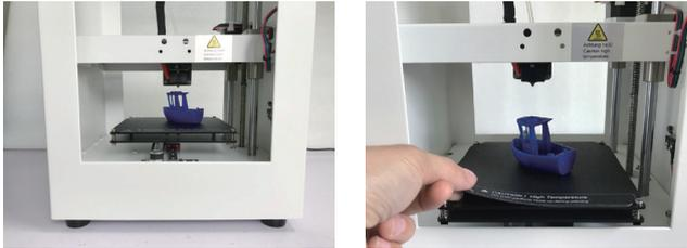
2. Retirez à la main les imprimés fins du BuildMat, sans aucun outil, et l'utilisateur peut maintenant terminer l'impression et obtenir ce qu'il veut.
