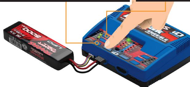
Presser et maintenir enfoncés le ou les boutons de démarrage pendant 1 seconde. Le chargeur émettra une tonalité indiquant que le chargement a commencé. Appuyer une fois pour arrêter. Le chargeur émettra une tonalité indiquant que le chargement a été annulé. Les voyants DEL s'allumeront progressivement au fil de la charge de la pile.
