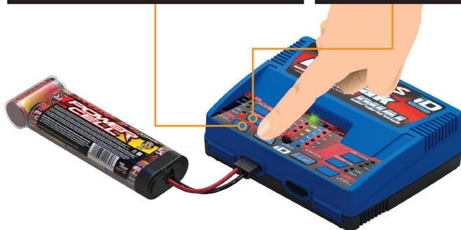
Presser et maintenir enfoncés le ou les boutons de démarrage pendant 1 seconde. Le chargeur émettra une tonalité indiquant que le chargement a commencé. Appuyer une fois pour arrêter. Le chargeur émettra une tonalité indiquant que le chargement a été annulé. Les voyants DEL s'allumeront progressivement au fil de la charge de la pile.
