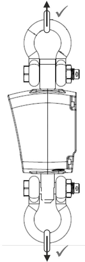
**N'utilisez que du matériel d'élingage, qui garantisse une fixation à 1 point à laquelle la balance peut être suspendue librement.**
