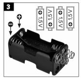
Placez 4 piles 1,5 V (type AA) dans le support de piles. Veuillez respecter la polarité.
