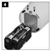
Installez à nouveau le support de piles dans le carillon avec les ressorts en avant
