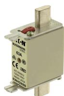
**Cartouche fusible, Basse tension, 63 A, AC 500 V, 120 kA, NH000, gL/gG, IEC, à double indicateur de fusion, pattes d'extraction conductrices**
