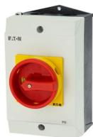
**Interrupteur général, P1, 25 A, Montage en saillie, 3 pôles + N, Fonctions d'ARRÊT D'URGENCE, Avec poignée rotative rouge et couronne de blocage jaune, verrouillable en position 0**
