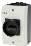
**Interrupteur de sécurité, tripolaire + 1 Contact F + 1 Contact O, 25 A, Fonction d'arrêt d'urgence, verrouillable en position « 0 » avec blocage du couvercle, Montage en saillie, avec plaque d'avertissement „Interrupteur de sécurité“**
