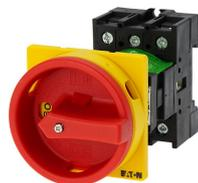
**Interrupteur général, P1, 32 A, Encastrement / Montage encastré avec fixation arrière, tripolaire, Fonctions d'ARRÊT D'URGENCE, Avec poignée rotative rouge et couronne de blocage jaune, verrouillable en position 0**
