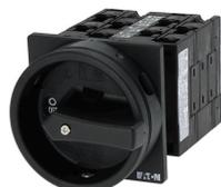
**Interrupteur général, T3, 32 A, Montage encastré, 4 Galette(s), 6 pôle, 1 Contact F, 1 Contact O, Fonction d'arrêt, avec poignée rotative noire et couronne de blocage, verrouillable en position 0**
