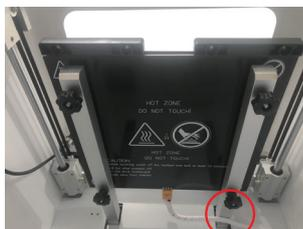
e) Une fois que les 4 étapes a, b, c et d sont terminées, il convient de répéter la section 3.2.2 pour effectuer l'étalonnage du décalage Z. Il est ensuite possible d'effectuer le nivellement automatique et de lancer l'impression.
