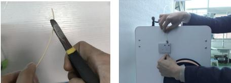
② Insérez le filament dans le tube jusqu'à ce qu'une longueur d'environ 5 cm soit visible à l'extrémité de l'extrudeuse.
