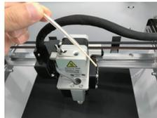
③ Faites délicatement coulisser le filament en avant jusqu'à ce que le filament alimente lentement l'extrudeuse automatiquement.
