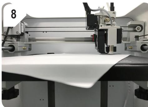
Activez le fonction d'étalonnage du décalage Z et mettez une feuille de papier A4 entre la buse et le plateau d'impression.
