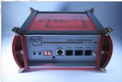
Tension de la voie = arrêt
