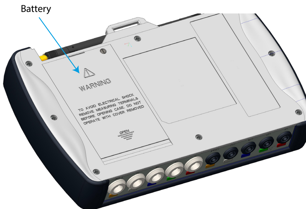
Figure 1: Position de la batterie.
