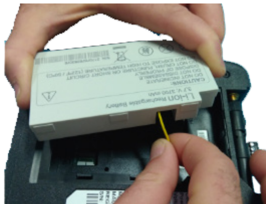
Figure 4: Insérez le câble de connexion à l'intérieur du couvercle de la batterie.
