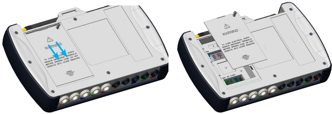
Figure 2: Extraction du couvercle de la batterie.
