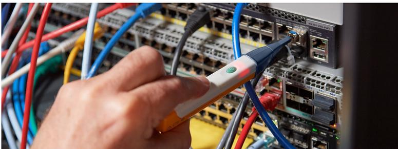
Déterminer si un émetteur-récepteur est opérationnel. FiberLert peut détecter les signaux fibre optique sans établir de contact.
