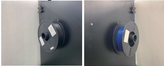
Installez le filament sur le côté gauche et le côté droit.
