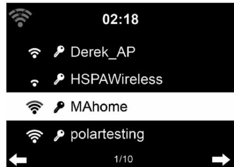
**Noter:** • Le nombre de barres dans le symbole sans fil devant le nom du réseau (SSID) indique la puissance relative du signal du réseau. • Le symbole de la clé indique que le réseau est protégé par un mot de passe. • Si le TX-187 ne trouve aucun réseau Wi-Fi et qu' «Aucun réseau sans fil n'est trouvé» s'affiche à l'écran, changez la position du TX-187 si nécessaire et vérifiez votre routeur Wi-Fi. Recherchez à nouveau le Wi-Fi par la suite.
