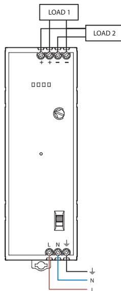
Schémas de raccordement pour 78.2K
