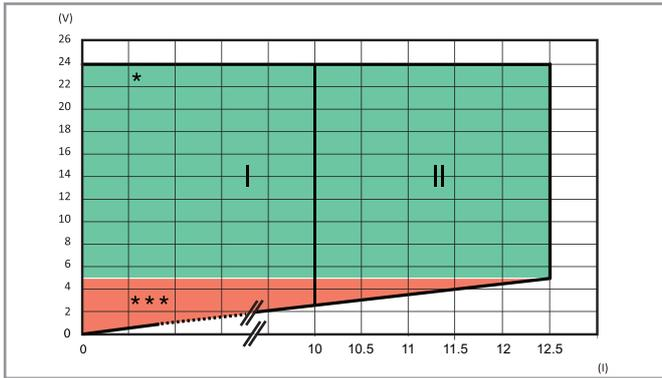
I : caractéristiques de sortie pour une température supérieure à 50 °C
