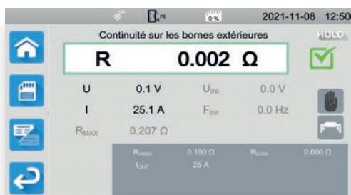
Exemple d'écran de résultat de mesure de continuité en 25 A avec connexion en 4 fils (CA 6163) en mode détaillé
