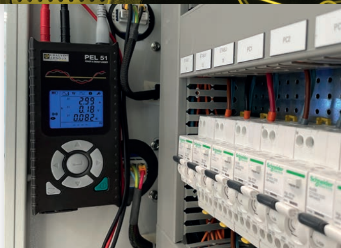
Boîtier aimanté, mise en place facilitée
