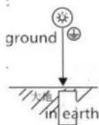
Attachez le fil de mise à la terre à la vis de mise à la terre située sur le dessus du commutateur et assurez-vous de la bonne connexion du système de mise à la terre.
