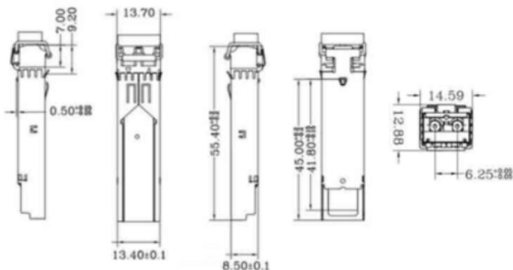
Connecteur LC, Gigabit, 20 km en monomode, simple fibre (DN-81020 et DN-81021)
