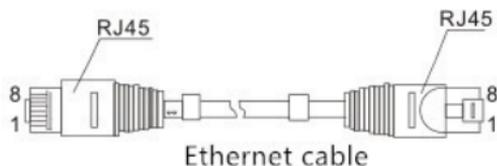
Le port RJ45 prend en charge la fonction Auto MDI/MDI-X, vous pouvez vous connecter directement au PC ou au serveur, ou vous connecter à d'autres commutateurs ou hubs. Pour les câbles dits « droits » (MDI), les broches 1, 2, 3, 4, 5, 6, 7, 8 correspondent à la connexion ; pour le port MDI-X d'un commutateur ou d'un hub, on utilise des câbles « croisés » : 1-3, 2-6, 3-1, 6-2, 4-7, 5-8, 7-4, 8-5. Les broches 1000Base-T (X) sont définies comme suit :
