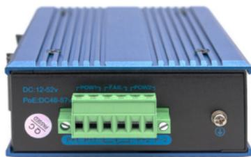
**Panneau latéral :** P1 et P2 sont les bornes de connexion, P+1 et P-1 correspondent respectivement aux pôles positifs et négatifs à connecter ; la vis de mise à la terre est utilisée pour la mise à la terre de l'appareil.
