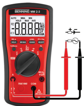
Illustration 10: Mesure de courant ou de fréquence
