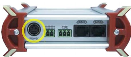
Insérez la fiche à 4 broches du câble de raccordement au bloc d'alimentation dans la prise "Power" située à l'arrière du B-6, en veillant à ce que la partie plate de la fiche soit orientée vers le haut.
