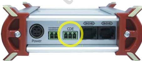
Pour raccorder les câbles au booster, utilisez le connecteur à 3 pôles fourni, dans lequel les câbles sont vissés.
