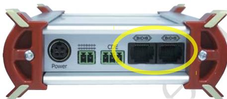
Reliez l'un des deux ports BiDiB du B-6 à l'interface PC BiDiB à l'aide d'un câble RJ 45. Les deux prises RJ 45 de l'interface BiDiB sont connectées en parallèle, vous pouvez donc utiliser n'importe quelle prise.
