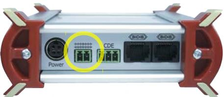
Pour le raccordement des câbles qui mènent à la voie, utilisez la pièce de connexion à 2 pôles fournie. Enfichez les câbles de raccordement dans le connecteur, vissez-les et enfichez ensuite le connecteur sur la prise à l'arrière du booster en veillant à ce que les vis soient orientées vers le haut.
