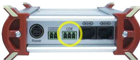
Verwenden Sie zum Anschluss der Kabel an den Booster den beiliegenden 3-poligen Steckverbinder, in dem die Kabel festgeschraubt werden.
