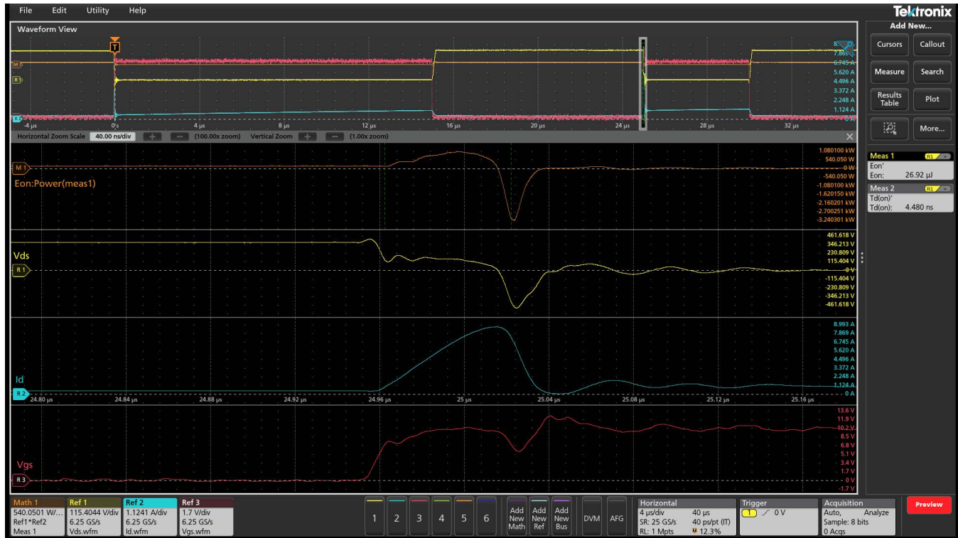
L'image montre les mesures de rétablissement inversé de diode avec courant de rétablissement inversé et tension capturée côté haut.
