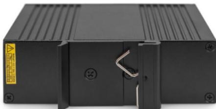
Insérez l'adaptateur dans le connecteur du rail DIN, puis vérifiez que le produit est correctement installé sur le rail DIN.
