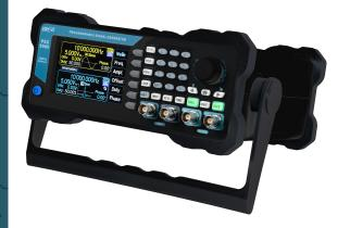
Le générateur de signaux programmable PSG9080 peut générer de nombreuses formes d'ondes différentes telles que des ondes sinusoïdales, carrées, triangulaires, des impulsions et des ondes définies par l'utilisateur. Le générateur de signaux dispose d'une large gamme de fréquences allant de 1nHz à 80MHz et d'un taux d'échantillonnage de 300 MSa/s. Le boîtier présente une finition de haute qualité et des pieds antidérapants pour assurer un environnement de travail confortable.
