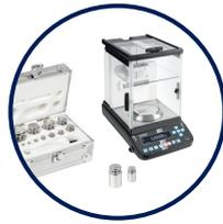
Une condition importante pour obtenir des résultats précis est que la balance et les poids de contrôle doivent être exposés à la même température et à la même humidité. Pour ce faire, le mieux est de les conserver au même endroit. Si ce n'est pas possible, rappelez-vous que, selon la taille des poids, l'acclimatation peut prendre un certain temps. Rapprochez donc les poids de la balance le plus tôt possible.
