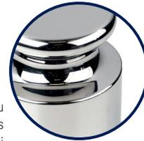
Les gouttes d'eau, la poussière ou les rayures peuvent rendre les poids de contrôle inutilisables. Surtout si plusieurs personnes utilisent les poids, vérifiez soigneusement s'ils sont intacts, propres et secs avant chaque utilisation. Souvent, le mieux est de nettoyer le poids, puis de laisser un certain temps s'écouler avant la prochaine utilisation. Si le poids a été utilisé dans un autre lieu, il est indispensable de prévoir un temps d'acclimatation suffisant.
