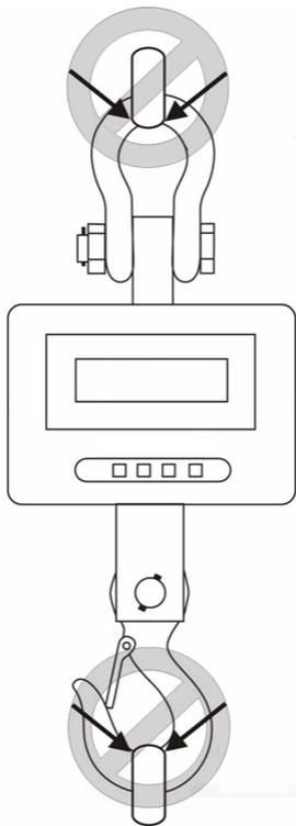
**N'utilisez pas des dispositifs trop volumineux pour suspendre la charge, ne permettant pas la suspension en un point.**
