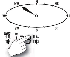
Er kan een alarm worden gegeven als de wind uit een bepaalde richting komt.
