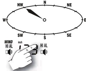
Il est possible d'activer une alarme quand le vent vient d'une certaine direction
