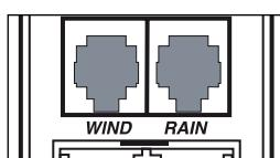
Points de raccordement pour le senseur de vent et de pluie sur l'unité d'émission.
