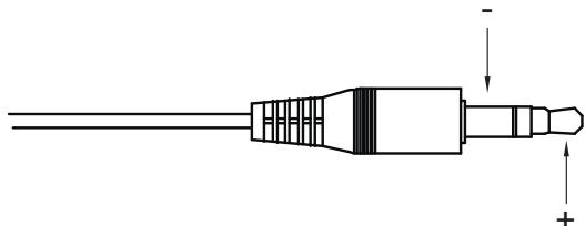
**Atención:** Comprueba la documentación técnica de tu dispositivo para determinar si el Módulo IR del IR Control 10 XTRA puede conectarse directamente. La mayoría de los cables IR usa una conexión mono jack de 3.5mm que se usa para los “Datos IR” y la manga para “GND”.
