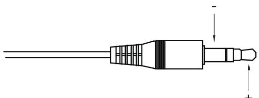
**Attenzione:** controllare la documentazione tecnica delle apparecchiature per determinare se il modulo IR dell'IR Control 10 XTRA può essere collegato direttamente. La maggioranza dei cavi IR è corredata di connettori da 3.5mm jack mono e si usa l'estremità per i dati IR ("IR Data") ed il rivestimento per "GND" (terra).
