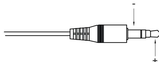
**Let op:** Controleer de technische documentatie van uw apparatuur om te bepalen of de IR Module van de IR Control 10 XTRA direct aangesloten kan worden. De meeste IR kabels gebruiken een 3.5mm mono jack aansluiting waarbij het uiteinde wordt gebruikt voor de "IR Data" en de mantel voor "GND".
