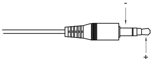
**Achtung:** Schauen Sie in der technischen Dokumentation Ihrer Geräte nach, ob das IR Modul des IR Control 10 XTRA direkt angeschlossen werden kann. Die meisten IR Kabel verwenden einen 3.5 mm Mono Buchsenanschluss, wobei der Ausgang für die "IR Daten" und der Mantel für "GND" verwendet wird.
