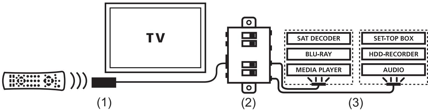
El IR Control 10 XTRA™ se compone de tres partes principales:
