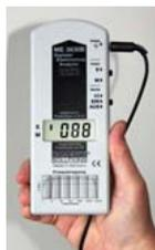
Unir la chifa del cable de tierra con el conector hembra previsto  $\perp$  y entonces conducir el cable al lado del aparato hacia atrás. Ni el cable de tierra ni el dedo deben destacar sobre el canto delantero del medidor (¡falsifica el valor medido!).
