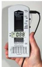
Inserire la spina jack del cavo di messa a terra compreso nella fornitura nell'apposita presa  $\perp$  e portare il cavo verso il lato posteriore dell'alloggiamento. Il cavo di messa a terra e le dita non possono sporgere oltre lo spigolo anteriore dello strumento di misurazione (ciò sfalsa il valore di misura ottenuto!).
