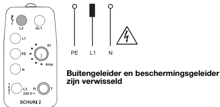
Afbeelding 7: Alleen lampje L2 brandt. Geen effect bij aanraking van de electrode.
