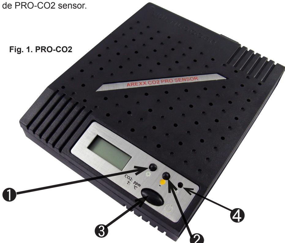
Na het inschakelen (schakelaar 3) gaat de LED branden en verstuur de sensor direct zijn eerste data.
