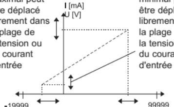
La tension d'entrée minimale ou le courant d'entrée minimal peut être déplacé librement dans la plage de la tension ou du courant d'entrée
