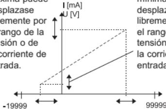
La tensión de entrada mínima o la corriente de entrada mínima puede desplazarse libremente por el rango de la tensión o de la corriente de entrada.
