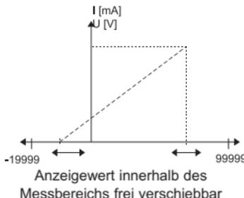
Anzeigewert innerhalb des Messbereichs frei verschiebbar
