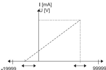
La plage de mesure choisie est de 0...20 mA. Affecter la valeur 0 au signal d'entrée le plus bas et 10 au signal d'entrée le plus haut. Pour l'affichage du total en tonnes, régler un facteur de 0,001.
